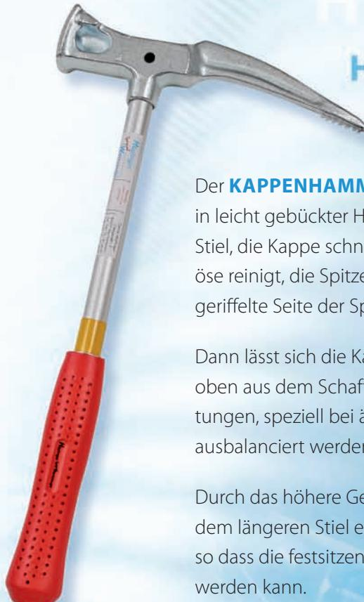
Der **KAPPENHAMMER** ist so konstruiert, dass man in leicht gebückter Haltung, bedingt durch den langen Stiel, die Kappe schnell locker klopft, dann die Kappenöse reinigt, die Spitze in die Öse einföhrt und die geriffelte Seite der Spitze mit dem Ösensteg verkrallt.
